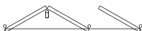
STRUCTURAL OUTWARD OPENING 2+1 3-PANELS FOLDING DOOR LOW THRESHOLD ΗΜΙΔΟΜΙΚΗ ΕΞΩ ΑΝΟΙΓΟΜΕΝΗ 2+1 3-ΦΥΛΛΗ ΦΥΣΟΥΝΑ ΧΑΜΗΛΟ ΚΑΤΩΚΑΣΙ
